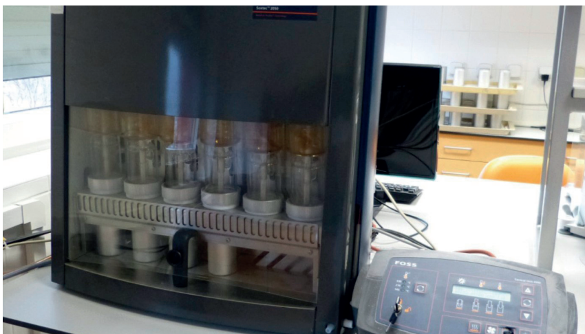
Obr. 8. Extrakce tuku na přístroji Soxtec 2050, stanovení tuku (Foto: L. Schebestová).
