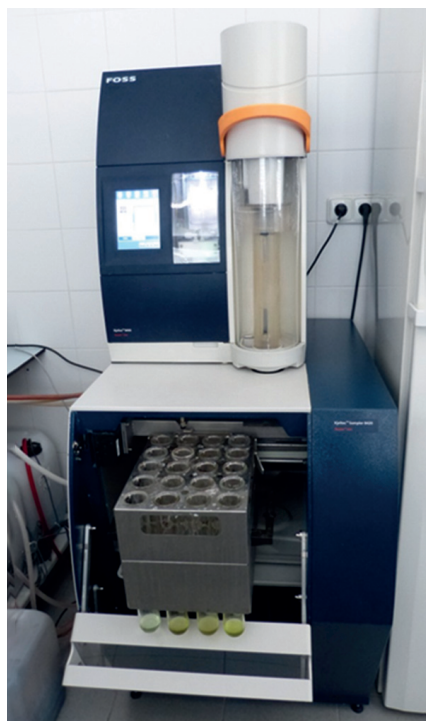
Obr. 10. Destilace a titrace mineralizátů vzorků filet na přístroji KJELTEC 8400 s KJELTEC sampler 8420, stanovení bílkovin (Foto: L. Schebestová).
