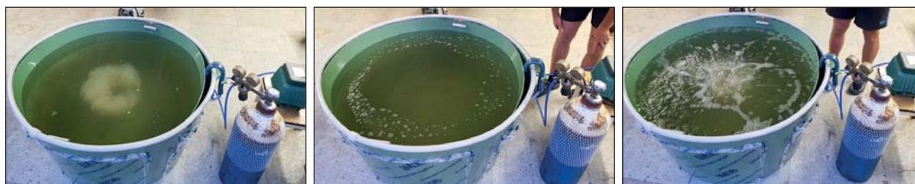
Obr. 6 – Ukázka fungování aerační vložky s oxygenací (A – vzduchování, B – oxygenace, C – spolu) (archiv J. Regenda).
