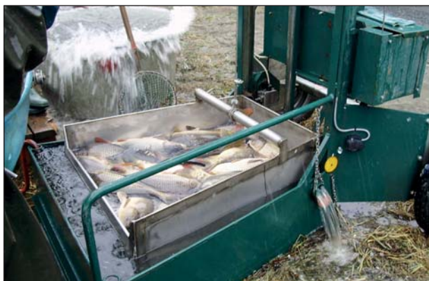
Obr. 4 – Upravený vertikální nakladač ryb, který má přepravní koš na ryby umístěný v nádobě s čistou vodou, která se obměňuje. Pád ryb z vážné mušle do koše nakladače s vodou je účinně tlumen – rybník Vrkoč, Rybníkářství Pohořelice, a. s. (foto J. Regenda)
