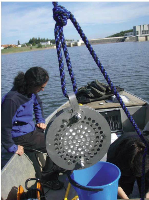
Instalace pasivních vzorkovačů POCIS na vodárenské nádrži Římov.
