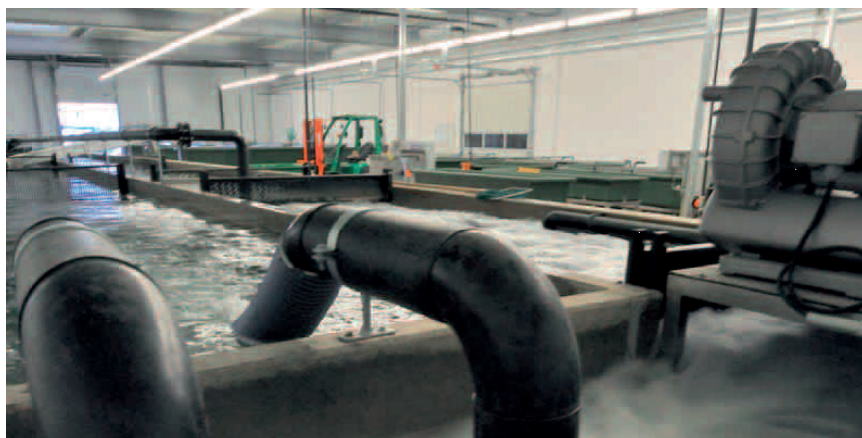
Obr. 28. Doprava vody s využitím airliftů poháněných vysokoobjemovou turbínou v chovu jesetera (podle www.uftag.de ).
