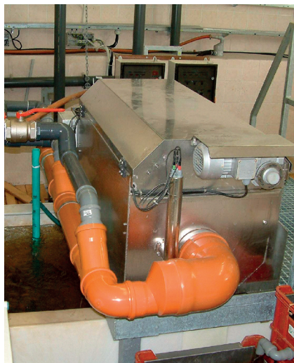
Obr. 10. Vnější pohled na zakrytý bubnový mechanický filtr IN-EKO. Foto P. Kozák.
