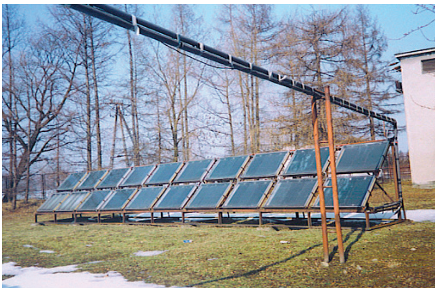
Obr. 31. Solární panely pro ohřev recirkulačního systému (Polsko). Foto J. Kouřil.
