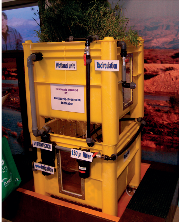
Obr. 34. Model recirkulačního systému s využitím kořenové čistírny (Izrael). Foto M. Flajšhans.
