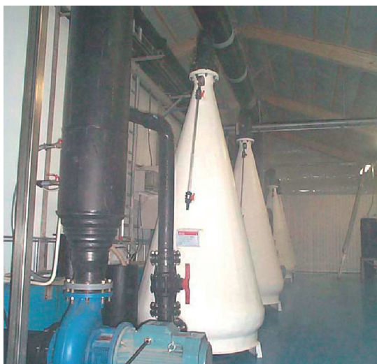
Obr. 25. Směšování kyslíku s vodou v recirkulačním systému s chovem úhoře (Nizozemí). Foto V. Stejskal.
