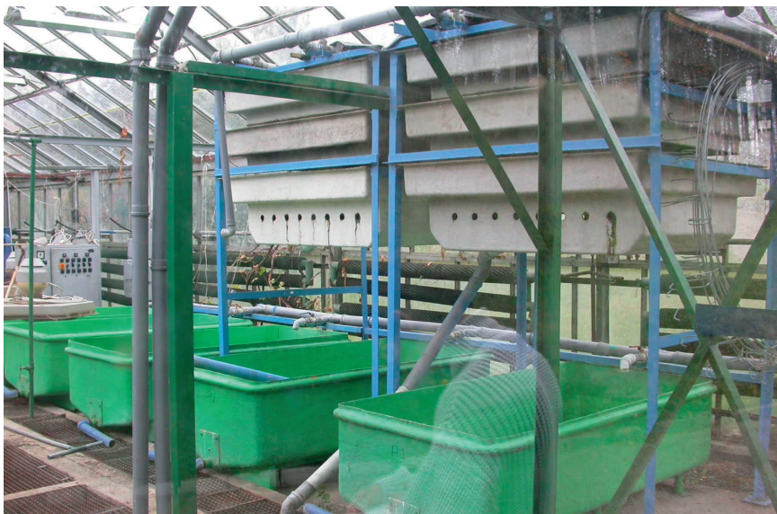
Obr. 15. Recirkulační systém na rybí líhni pro teplomilné druhy ryb umístěný ve skleníku (Polsko). Vpravo nahoře zkrápěné filtry. Foto J. Kouřil.
