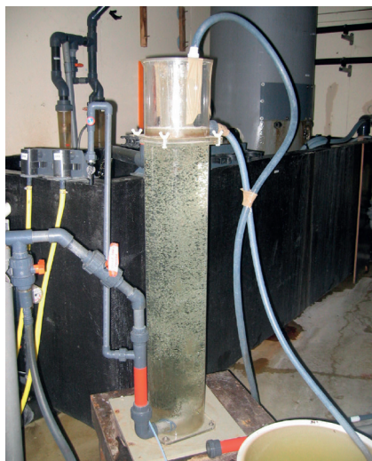
Obr. 12. Flotace s využitím přisávaného podtlakového vzduchu. Foto J. Kouřil.
