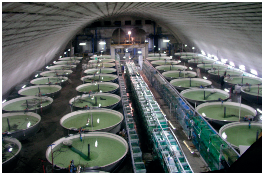
Obr. 7. Recirkulační systém původně využíváný pro intenzivním odchov úhoře, v současnosti k chovu tropických akvarijních ryb (Slovensko). Foto T. Polícar.
