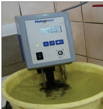
Obr. 10. Lázeň o teplotě 40 °C připravená pro rozmrazování.
