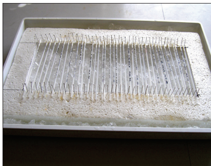
Obr. 6. Rámeček s označenými a naplněnými pejetami na ledu ( 0\text{--}2\text{ }^{\circ}\text{C} ).
