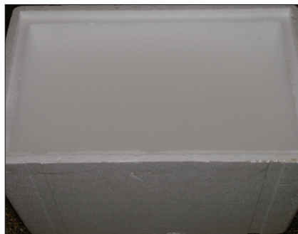
Obr. 7. Polystyrénový box o hloubce 35 cm, s výškou hladiny kapalného dusíku 7–10 cm.
