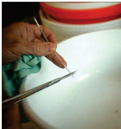
Obr. 11. Odstrížení vodou ontaminovaného konce pejety.
