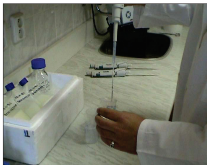
Obr. 5. Nasávání naředěného spermatu mikropipetou do označených pejet.
