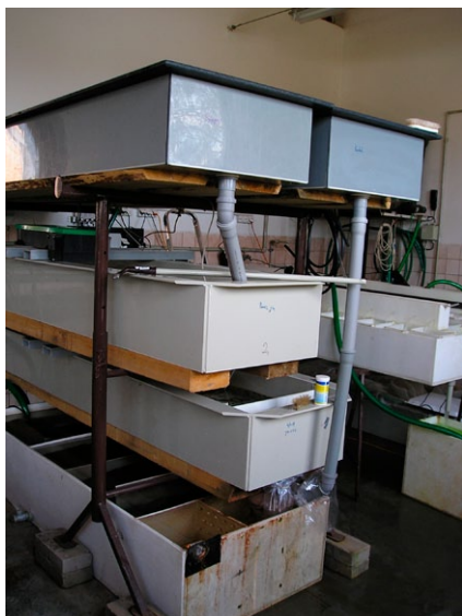
Obr. 9. Recirkulační systém odchovných žlabů s mechanicko-biologickým filtrem. V systému je zařízen termostatem řízený ohřev recirkulované vody a UV filtr o výkonu 18 W (foto D. Gela).
