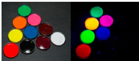
Obr. 8. Vzorky deseti barevných variant elastomerů na denním světle (vlevo) a osvětlené UV lampou (vpravo) (foto NMT, 2008).
