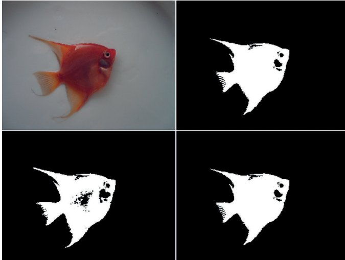
Obr. 19. Příklad segmentace v chromatických barvách pomocí Otsu metody automatického prahování. Nahoře vlevo originální obrázek, nahoře vpravo binární obrázek jako výsledek prahování v chromatické červené. Dole vlevo binární obrázek jako výsledek prahování v chromatické modré. Dole vpravo binární obrázek vzniklý váženým průměrem binárních obrázků z jednotlivých chromatických kanálů. Jak vidíme, v tomto případě byla pro segmentaci dostačující informace z chromatického červeného kanálu.
