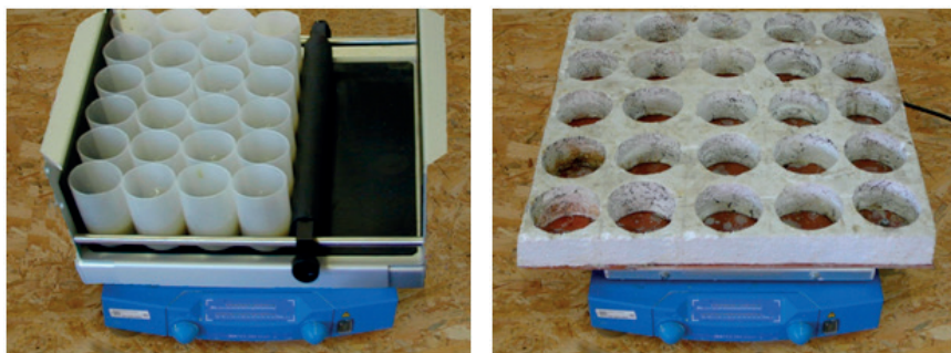
Obr. 9. Ukázka míchacího (třepacího) pultu s různými nástavci na umístění nádob s jikrami (Vlevo – dodávaný prodejcem přístroje; vpravo – zhotovený vlastními silami).
