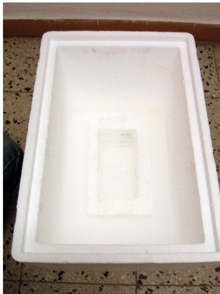
Obr. 7. Polystyrénový box s plovoucím rámečkem a pejetami v parách kapalného dusíku (teplota po uzavření boxu v místě pejet -130\text{ }^{\circ}\text{C} ) (foto M. Rodina).
