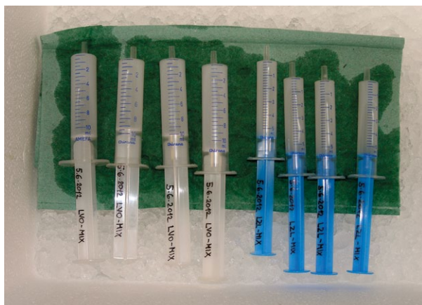
Obr. 3. Sperma lína s imobilizačním roztokem v injekčních stříkačkách o objemu 5–10 ml uchovávaných po dobu max do 5 h na ledu při teplotě 0 až +2 °C (foto M. Rodina).
