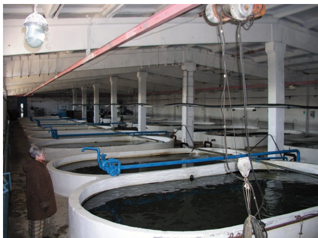
Obr. 4. Hala s nádržemi pro přechovávání velkých generačních ryb (zejména vyza, j. ruský) před výtěrem, odlovených z volných vod (nahore je patrná kolejová dráha pro místní transport generačních ryb v zavěšeném stavu, např. do jiné nádrže, na výtěr apod.) na jeseteří farmě (Astrachani, Rusko, foto a komentář J. Kouřil).
