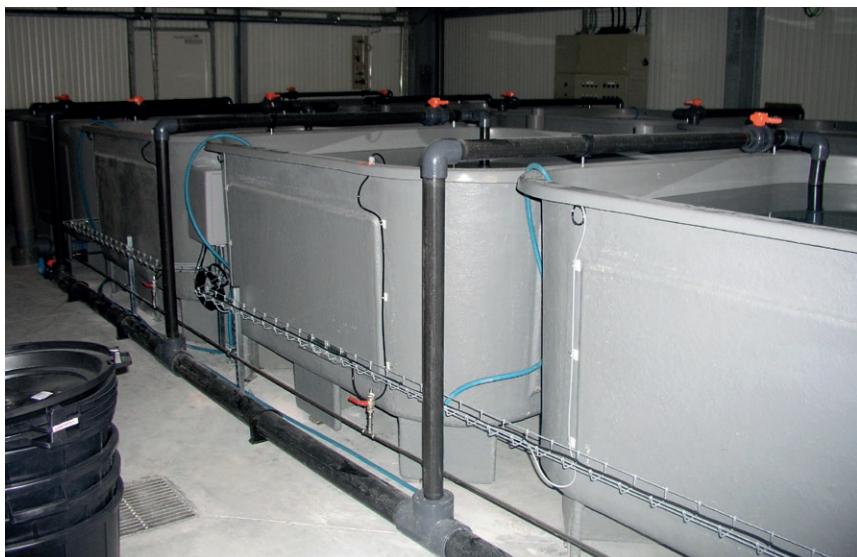
Obr. 4. Vhodný recirkulační akvakulturní systém využívaný pro intenzivní chov starších věkových kategorií candáta obecného, Sander lucioperca (L.) (foto T. Polícar).
