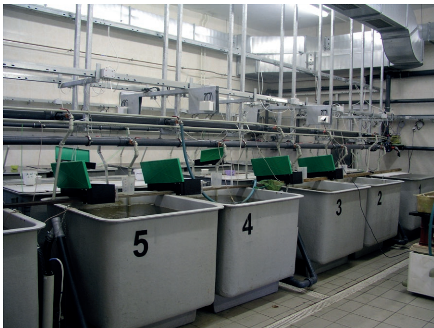
Obr. 5. Recirkulační akvakulturní systém FROV JU využitý k realizaci ověřeného technologického procesu adaptace a intenzivního chovu juvenilních ryb candáta obecného, Sander lucioperca (L.) (foto T. Polícar).
