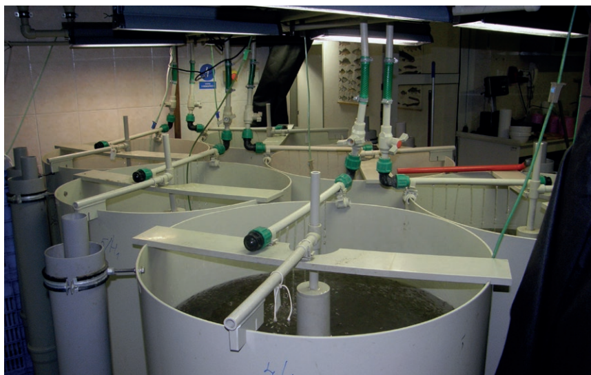
Obr. 23. Recirkulační akvakulturní systém využívaný při intenzivním odchovu štiky obecné ( Esox lucius L. ) do stadia rychleného plůdku (foto T. Polícar).
