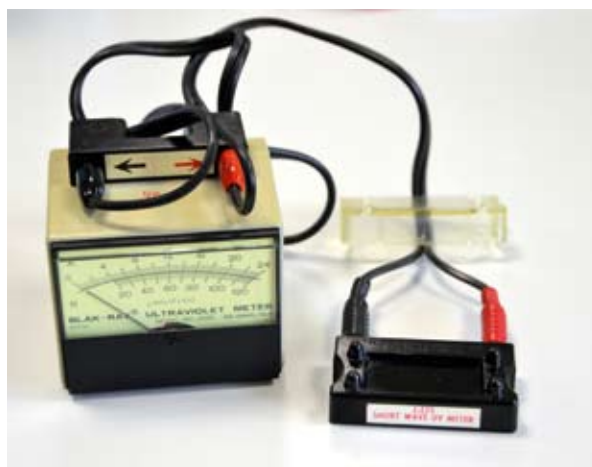
Obr. 4. Radiometr Blak-Ray UVP (USA) s J-225 (220–290 nm) senzorem pro měření světla UV-C o intenzitě 0–120 W.m -2 . Foto I. Lebeda
