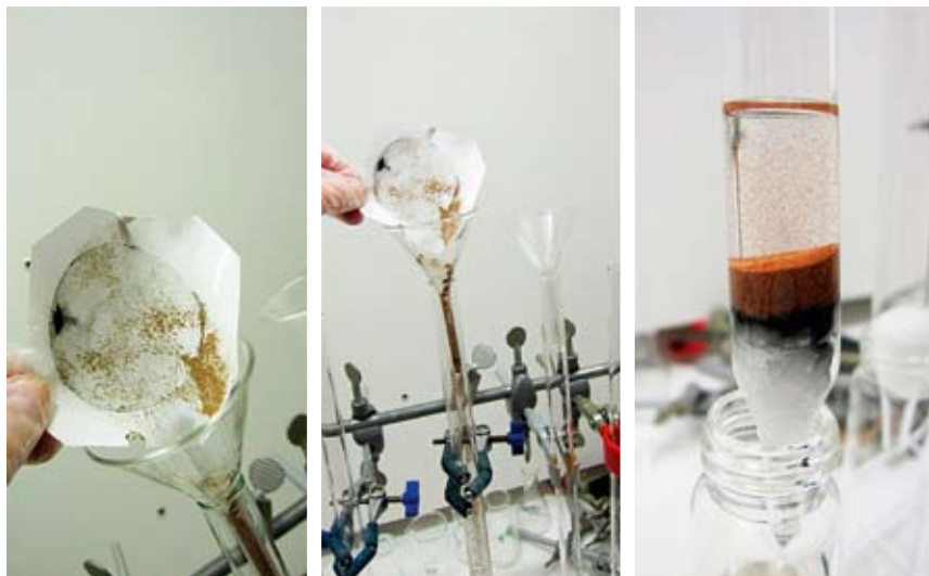
Obr. 15. První krok extrakce POCISu – přenos sorbentu na kolonu (Foto: K. Grabicová, O. Golovko).
