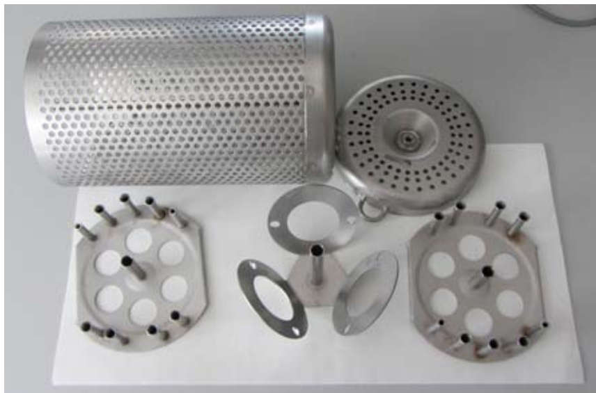
Obr. 3. Sestava ochranné klece se dvěma nosiči SPMD a jedním nosičem POCIS (Foto: R. Grabic, K. Grabicová).
