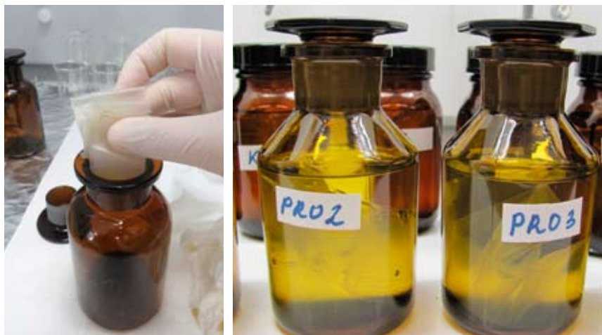
Obr. 11. Extrakce SPMD membrán – dialýza (Foto: K. Grabicová, O. Golovko).
