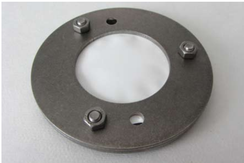
Obr. 2. Vzorkovač pro stanovení polárních organických chemických látek – POCIS (Foto: R. Grabic, K. Grabicová).
