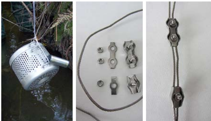
Obr. 7. Umístění klece s pasivním vzorkovačem a teploměrem do vzorkovaného média, vpravo pak spojky pro ocelová lanka (Foto: R. Grabic, K. Grabicová , T. Randák).
