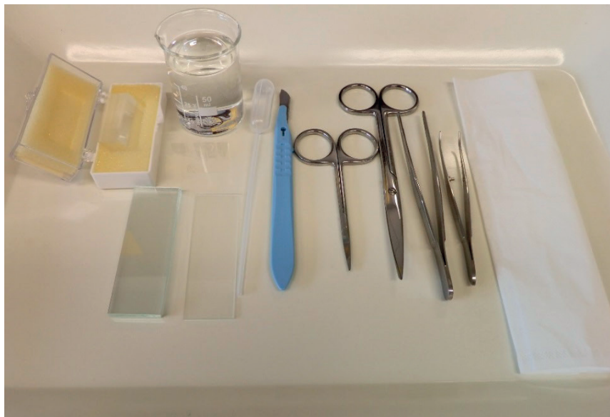
Obr. 1. Pomůcky pro odběr a přípravu vzorků – zleva: krycí sklíčka, kádinka s vodou a podložní sklíčka, plastová pipetka, skalpel, oční nůžky, pitevní nůžky, pinzety, papírová utěrka (Foto: Ch. Steinbach).
