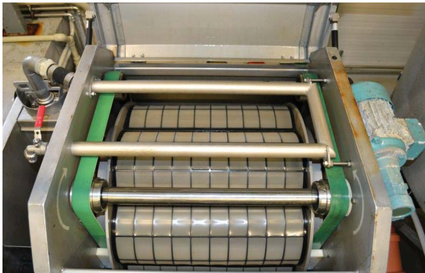
Obr. 5. Odkrytý mechanický mikrosítový bubnový filtr (Foto: J. Hampf).
