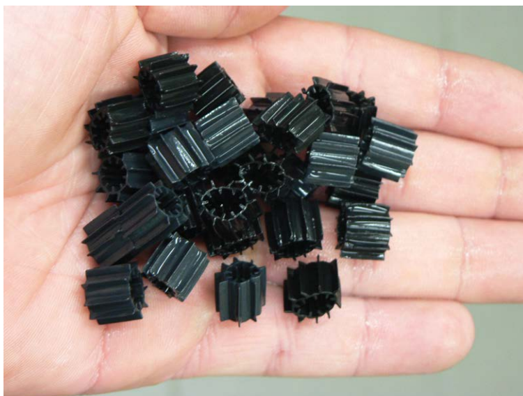
Obr. 7. Plastové filtrační médium tvořící náplň biologického filtru (Foto: T. Polícar).
