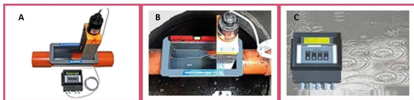
Obr. 12. Měrná (A, B) a vyhodnocovací (C) jednotka využívající Palmer-Bowlesův žlab (Di-box, 2018)
