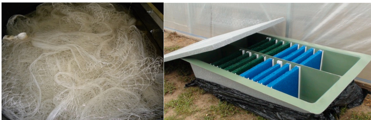
Obr. 14. Vlevo – nylonové ptačí sítě, které jsou levné a efektivní v zachycování nerozpuštěných látek, ale velmi problematické pro jejich náročné čištění. Vpravo – filtr s matracemi Matala, jež jsou vyráběny v různých hustotách filtračního materiálu (podle toho jsou barevně odlišeny). Jsou efektivní v zachycování nerozpuštěných látek a jejich čištění je jednodušší (Donaldson, 2017).
