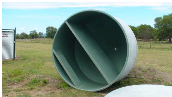
Obr. 10. Čiřič používaný v akvaponickém systému Univerzity na Panenských ostrovech. Voda vstupuje do malé komory a je tlačena dolů. Jakmile vstoupí do druhé komory, je tlačena do ještě větší hloubky, což napomáhá sedimentaci nerozpuštěných látek na dně kónusu (Donaldson, 2017).
