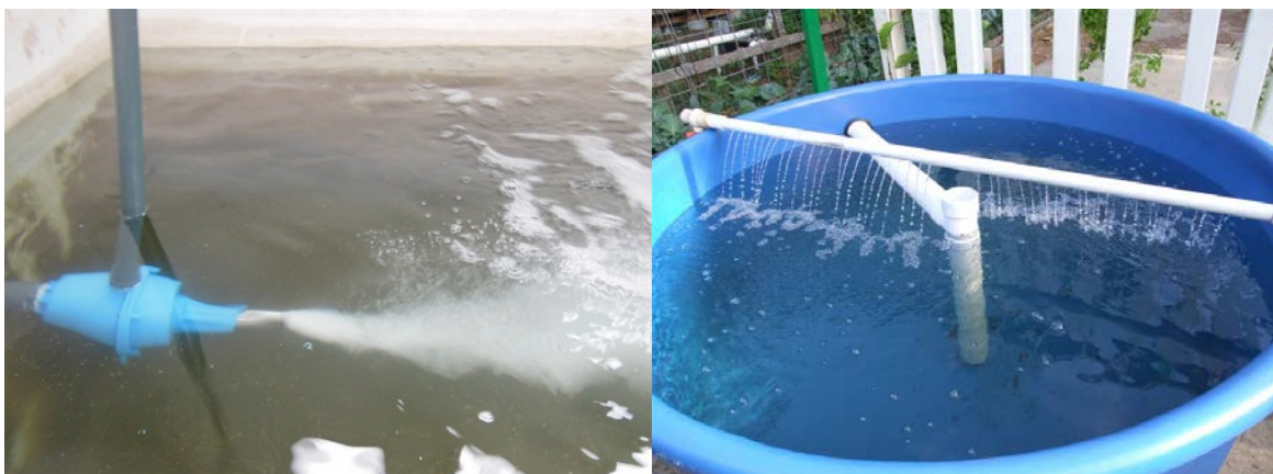
Obr. 23. Vlevo – příklad využití jevu Venturiho trubice pro aeraci vody (Chromý, 2017). Vpravo – příklad využití rozstříku přítoku vody pro aeraci (Aquaponic Lynx, 2017).
