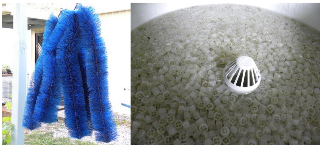
Obr. 15. Vlevo – filtrační kartáče, které jsou relativně levné, efektivní v zachycování nerozpuštěných látek a dobře se čistí. Vpravo – komerčně vyráběná biomédia pro biofiltry, jež jsou efektivní v zachycování nerozpuštěných látek, čistí se za použití intenzivního provzdušňování a následného odkalení (Donaldson, 2017).
