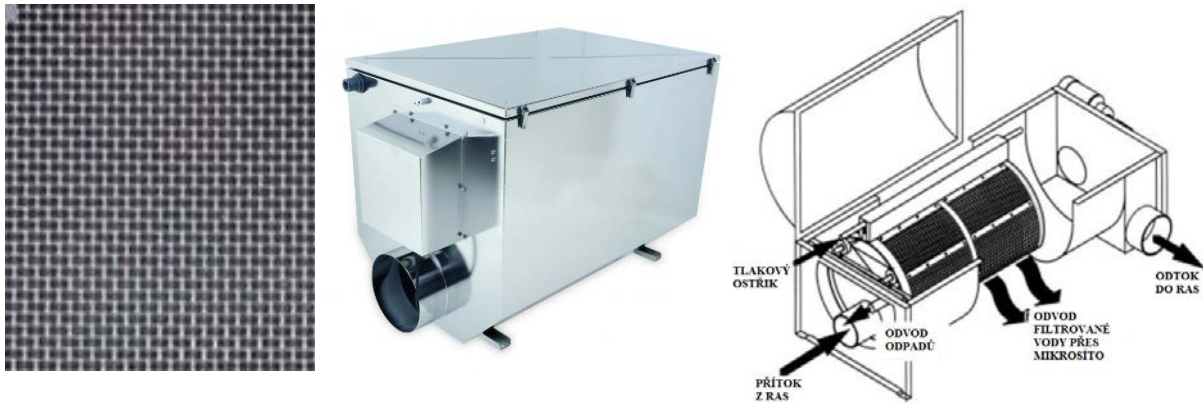
Obr. 17. Zleva – mikrosíto, boční pohled na bubnový filtr a popis jednotlivých částí filtru (upraveno dle Donaldson, 2017).
