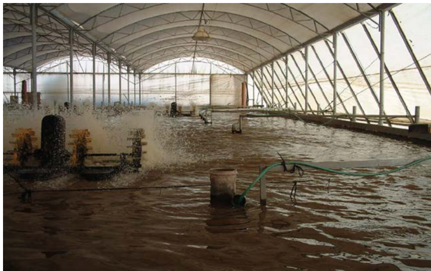
Obř. 8. Lopatkový aerátor používaný zejména při chovu krevet v BFT zajiřtuje dostatečné promíchávání vodního sloupce (Avnimelech, 2012).
