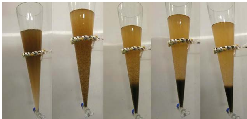
Obr. 5. Imhoffovy konusy při měření množství nerozpuštěných látek a přítomnosti vloček v nádrži (Foto: R. Lunda).
