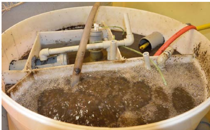
Obr. 14. Model čistírky odpadních vod zkonstruovaný pro experimentální účely (Foto: R. Lunda).
