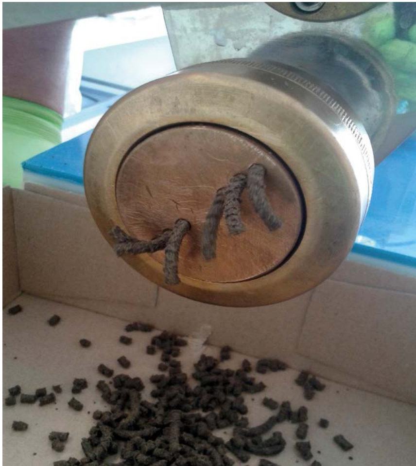
Obr. 18. Výroba nových pelet pomocí studené extruze (Foto: R. Lunda).
