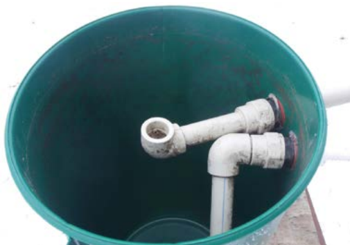
Obr. 12. Mechanická odstředivka pro separaci a snížení množství nerozpuštěných látek v BFT systému (Foto: R. Lunda).
