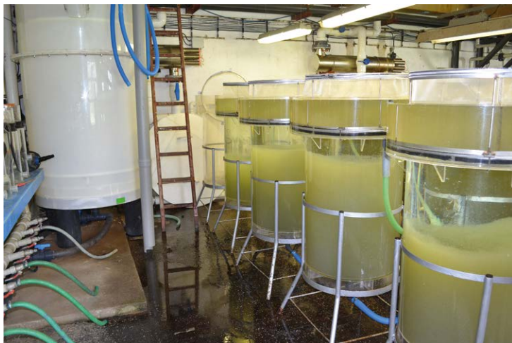
Obr. 19. Velkokapacitní inkubační přístroje Amur s nasazenými jikrami amura bílého ( Ctenopharyngodon idella ) (Foto: J. Kouřil).
