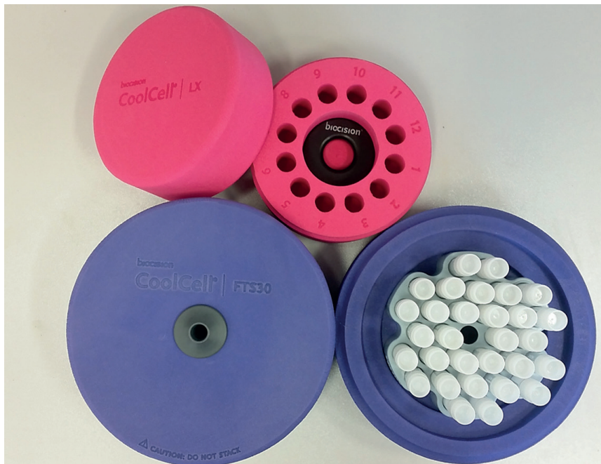
Obr. 3. Mrazicí krabičky s kapacitou pro 12 a 30 kryozkumavek o objemu 2ml, které po vložení do hlubokomrazacího boxu (-80 °C) zajišťují kontrolovaný pokles teploty -1 °C.min -1 (Foto: R. Franěk).
