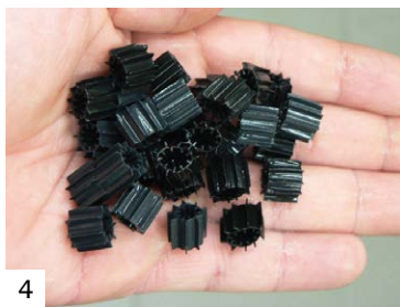
Obr. 1 a 2. RAS FROV JU, VÚRH Vodňany (Foto: J. Kolářová, T. Policar). Obr. 3. Biologický filtr (Foto: J. Kolářová). Obr. 4. Plastové komponenty biologického filtru (Foto: T. Policar).
