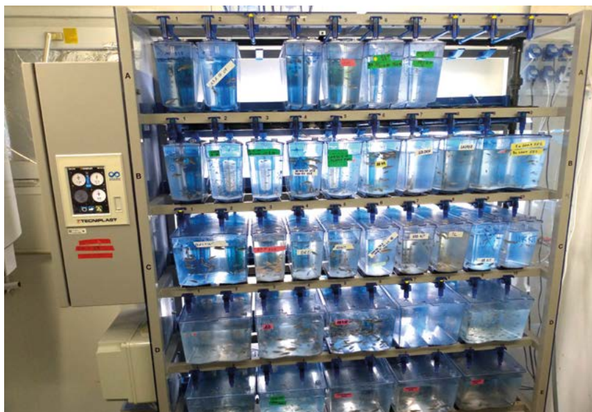
Obr. 2. Recirkulační systém pro chov dánií (Foto: R. Franěk).
