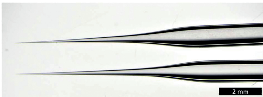
Obr. 10. Doporučený tvar mikrokapilár pro injekci embryí dánia pruhovaného. Při vytahování skleněných kapilár je důležité optimalizovat nastavení (teplota a množství závaží) tak, aby bylo dosaženo co nejmenšího průměru špičky. Pro injekce nedechorionovaných jiker je zároveň zásadní, aby první 1–2 mm kapiláry měly co nejmenší průměr, aby nedocházelo k roztržení chorionu (Foto: R. Franěk).
