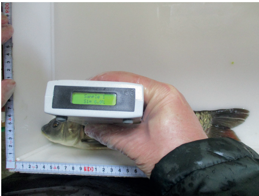
Obr. 7. Měření obsahu tuku ve svalovině amurského lysce s využitím tukoměru Fish Fatmeter FM 692 (Foto: M. Prchal).
