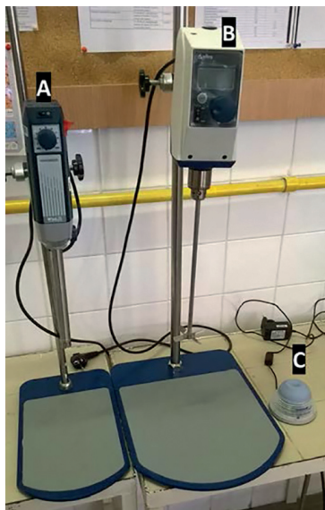
Obr. 4. Přístroje nezbytné k přípravě mikročástic: A) homogenizátor, B) mechanické hřídelové míchadlo, C) laboratorní vortex (Foto: J. Vysloužil).
