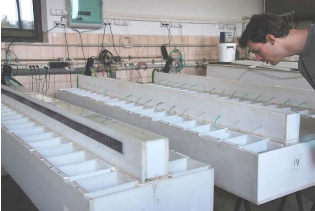
Obrázek 14: Experimentální inkubátor s recirkulovanou vodou ošetřenou UV zářením pro inkubaci jiker při optimalizaci způsobu oplození. (foto V. Kašpar)
