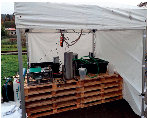
Obr. 4. Ukázka technologické sestavy pro indukci triploidie šokem hydrostatickým tlakem pro práci v terénu. Vlevo mimo stan zásobní láhve se stlačeným vzduchem, na paletách vysokotlaký kompresor s pojistným ventilem, vysokotlakými hadicemi, redukčním ventilem a násobičem, uprostřed tlaková láhev (komora) v ochranném nerezovém plášti. Vzadu a vpravo inkubační vaničky s vložkami a termostaty pro řízenou inkubaci jiker do začátku šoku (Foto M. Flajšhans).
