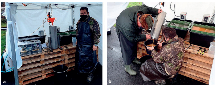
Obr. 7. a) Tlaková komora opatřená nálevkou k naplnění jikrami; b) vylévání ošetřených jiker z tlakové komory po skončeném šoku. Operátoři jsou maskováni ochrannými prostředky dýchacích cest (pandemie Covid-19) (Foto M. Flajšhans (vlevo) a M. Pumpř (vpravo)).
