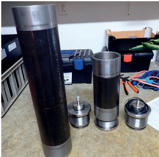
Obr. 6. Obě silnostěnné tlakové komory (s vnitřním objemem 3 l i 1 l) v průběhu výroby v SZDT, s.r.o. v Lišově. Vedle komor jsou demontovaná (vyšroubovaná) horní víka. Na malobjemové tlakové komoře vpravo je i částečně vyšroubované dno. Tyto úpravy umožňují úplné vyčištění vnitřního prostoru komory v případě, že by v ní byly ošetřeny nedokonalé odlepkované jikry (Foto M. Flajšhans).
