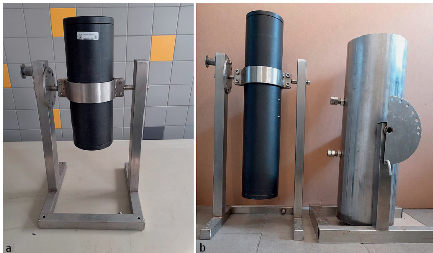
Obr. 5. a) silnostěnná tlaková komora o vnitřním objemu 1l pro experimentální maloobjemové indukce triploidie; b) vlevo silnostěnná tlaková komora o vnitřním objemu 3l pro poloprovozní a provozní indukce triploidie a vpravo v ochranném pláští z nerezové oceli tlaková láhev o vnitřním objemu 7l pro provozní indukce triploidie. Všechny tři tlakové komory jsou umístěny v nerezových stojanech s aretací, které umožňují po provedeném šoku tlakovou komoru ve stojanu vyklonit a ošetřené jikry s vodou vylít (Foto M. Flajšhans).
